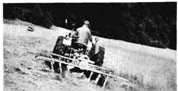
Bild 3. Traktor ITM 533 beim Mähen und Zetten am Hang. Das Schneidwerk arbeitet talseitig, die Hangneigung beträgt 30 %
