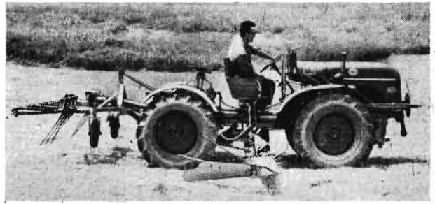
Bild 2. Allradtraktor BTG 4/32 mit Mähwerk und Rüttelzetter E 251 auf hängigem Grünland. Die Hangneigung beträgt 30 %
