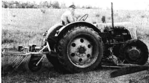
Bild 1. Traktor RS 14 30 A mit angebautes Mähwerk E 092 und Büttelzetter E 251. Die normale Vorderachse ist gegen eine Triebachse ausgetauscht worden
