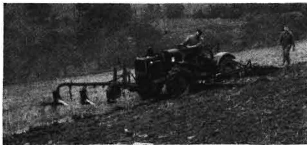
Bild 1. Die Versuchsausführung des Zweige-BTG mit dreifurchigen Pflügen und schwerem Eggenfeld am Seitenausleger bei der Arbeit an einem 25 % geneigten Hang
