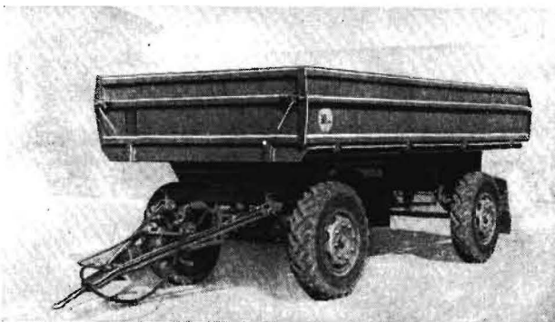
Bild 3. Nachrüstbare Aufsatzbordwände 200 mm hoch. Schraubverbindung. Die Anbringung eines zweiten Verschlusses für diese Höhe ist nicht notwendig
