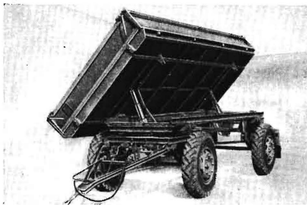
Bild 1. THK 5 mit rungenlosen Bordwänden (400 mm hoch — Ausführung ab 1966) in Kippstellung: kombinierte Druckluft-Auflaufbremse, Hand- und Motorhydraulik
