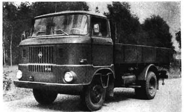
Bild 1. LKW „IFA W 50 L“ — ein moderner Frontlenker-Lastkraftwagen. Nutzmasse 5300 kg. Wassergekühlter 4-Zylinder-Dieselmotor. Höchstgeschwindigkeit 83 km/h
