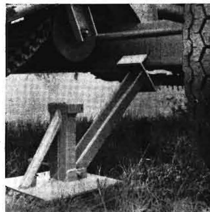
Bild 3. Die angesetzte Vorrichtung zum Aufbockvorgang an einer Kartoffelvollertemaschine E 675
