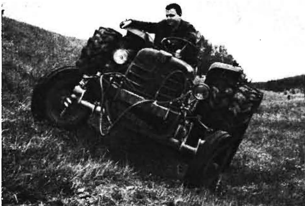
Bild 2. Zetor 3011 mit niedrigem Schwerpunkt, zwillingbereifte, mit Wasserfüllung in den Hinterrädern
