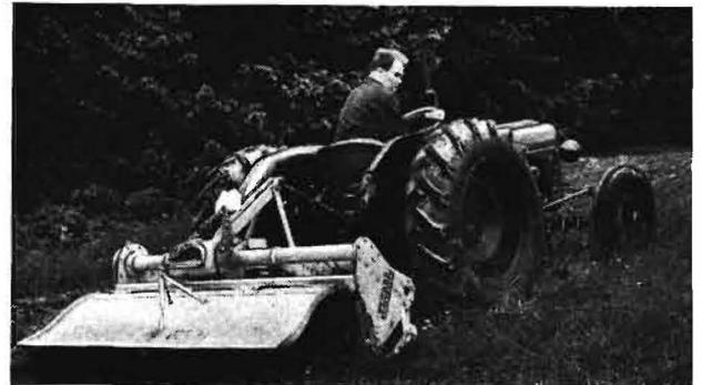
Bild 1. Zetor 3011 mit niedrigem Schwerpunkt, mit angebaute Rotator
