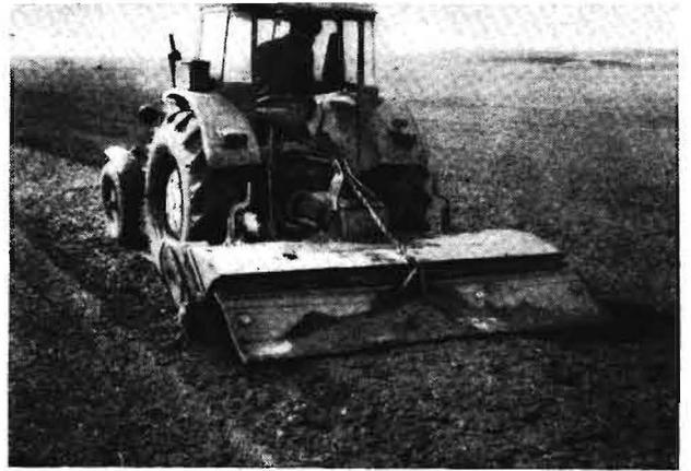
Bild 1. Rotorkrümler, im Institut für Landmaschinen Chodov (ČSSR) entwickelt, hinter dem Traktor Z 4011
