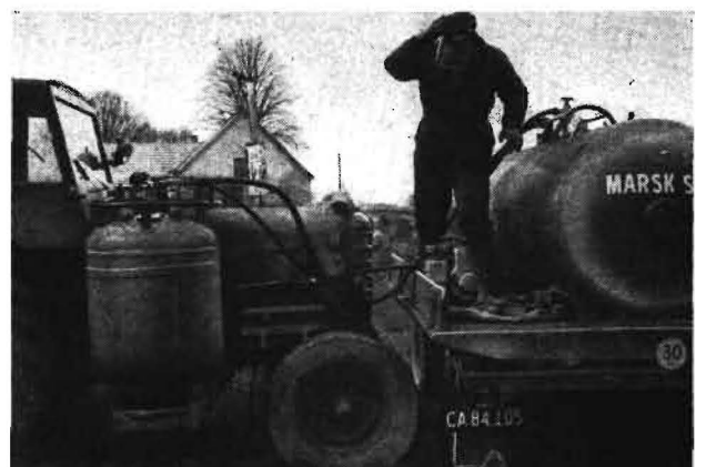
Bild 3. Auf jeden Traktor sind 2 Tanks montiert, sie fassen 160 bis 240 kg Ammoniak
