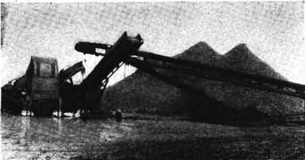
Bild 3. Kartoffel-Stein-Trennanlage im Einsatz; im Hintergrund die durch die Trennanlage aus der Rohware abgetrennten Steine
