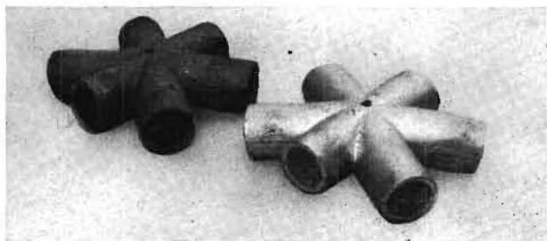
Bild 4. Knotenpunkte für Stabnetzwerke aus Temperguß. Sie sind zweischalig, die Stäbe werden zwischen die beiden Schalen geklebt
