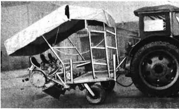
Bild 3. Pflanzmaschine A 832 mit Zusatzausrüstung „Sonnenschutzdach, hydraulische Aushebung und Erdtopfpflanzvorrichtung“ in Transportstellung
