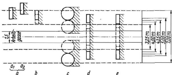
Bild 6. Seitliche Auslage verschiedener Bodenpflegegeräte für den Obstbau und Anpassung an Reihenabstände nach TGL 8237; a Einfachscheibenegge OET (UVR),  $a_1$  ... als Frontanbaugerät und  $a_2$  ... als Heckanbaugerät; b Rotorkrümler MRH (UVR); c Kreiselegge TFB (UVR); d Anbau-Einfachscheibenegge B 490 (DDR); e Versuchsgerät (DDR)
