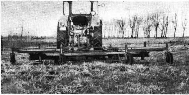
Bild 3. Scheibenmäherwerk in Arbeitsstellung, Arbeitsbreite 4,20 m
