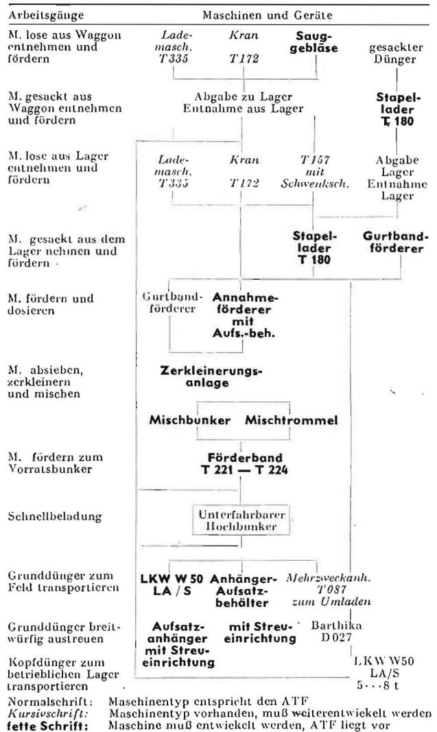
Bild 2. Maschinenkomplex zum Arbeitsverfahren: 85.1. Düngung durch das Zentrale Düngerlager (TUL-Betrieb) 85.1. 2.1. Feste Mineraldünger (lose bzw. gesackt)
