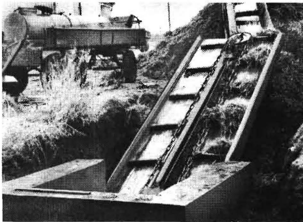
Bild 2. Ungesicherte Grube des Schrägförderers außerhalb des Stalles
