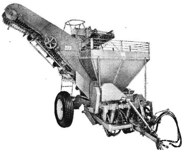
Bild 5. Bunker-Köpfröder John Deere 223 (USA), die Köpffaggregate sind hier nicht angebracht
