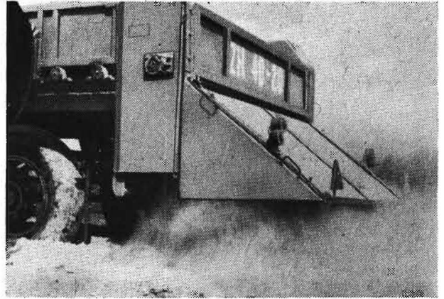
Bild 4. Rollbodenanhänger mit in der Breite verstellbarem angebautem Kasten. Im Kasten sind zwei Streuteller zur Breitverteilung angeordnet
