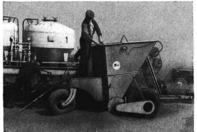
Bild 6. Gerät 4 bei der pneumatischen Füllung mit Filterasche. Unter der Zellenradschleuse ist das während der Füllung im Stand ausgetretene Fördergut angehäuft
