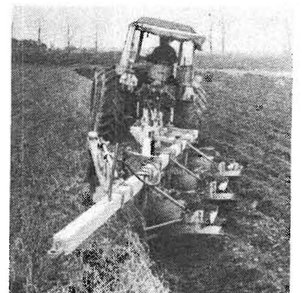
Bild 2. Aufsattel-Beetpflug B 200-4 während der Arbeit
