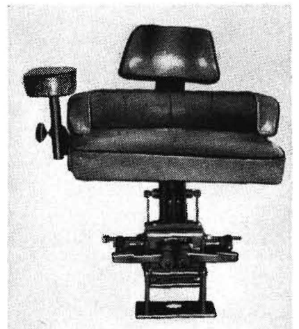
Bild 4. Neuentwickelter Traktorsitz (gegenüber dem Sitz TWS III verbesserte Ausführungsform). Seitenansicht
