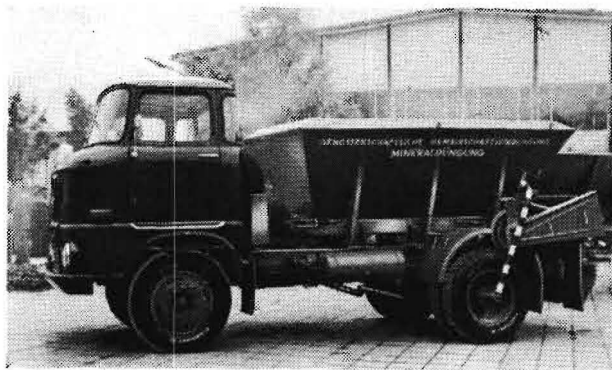
Bild 3. Kombiniertes Transport- und Ausbringefahrzeug (mit Schleuderdüngerstreuaufsatz D 032)
