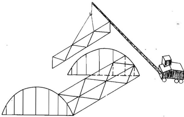
Bild 10. Montage einer Stabnetzwerktonne aus vorgefertigten Leitern
