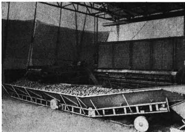
Bild 1. Annahmeförderer T 237 als Dosierelement
