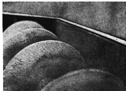
Bild 2. An der Förderschnecke anhaftende Teilchen
