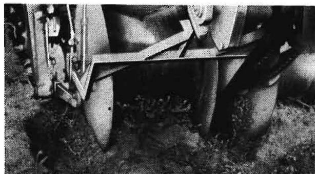
Bild 2. Die unteren, verhärteten Dammlanken werden durch die Scheibenseche gut abgetrennt
