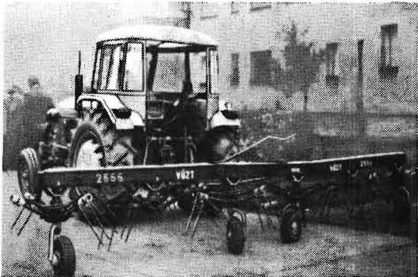
Bild 2. Dieser Redwender der holländischen Firma Zweger ist eine Einzweckmaschine. Nach Angaben des Herstellers erreicht das Gerät beim Zelten und Wenden von Grünfutter eine Flächenleistung von 5 ha/h
