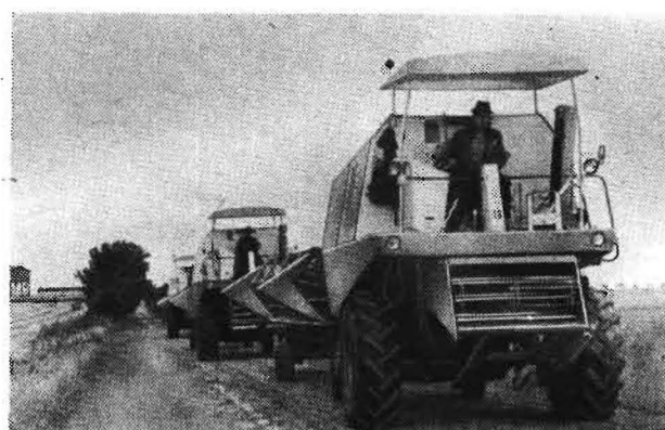
Bild 1. Mähdrescher E 512 auf dem Transport mit angehängtem Schneidwerk (zu Seite 293)
