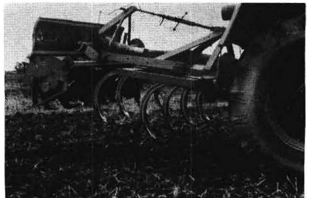
Bild 1. Funktionsmuster einer Grubber-Fräskombination Einsatzversuche mit diesem Gerät zeigten positive Ergebnisse
