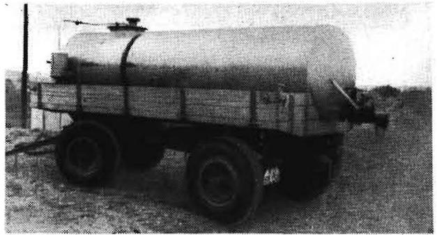
Bild 2. 5-t-Anhänger mit Behälteraufsatz 5 000 l
