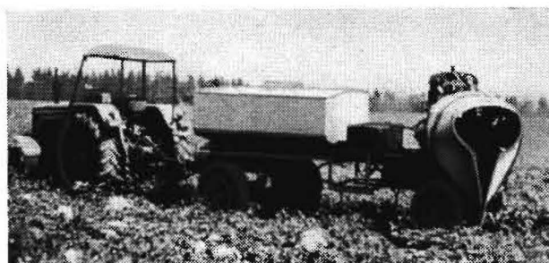
Bild 3. Das auf einem Drehkranz befestigte Sprühaggregat läßt sich um etwa 220° schwenken
