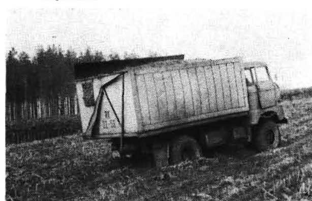
Bild 2. W 50 LAZ mit automatisch öffnendem Häckselaufbau und Niederdruckreifen 16-20. Mit gehäckseltem Marktammkohl aus Unachtsamkeit mit 8600 kg überladen, bei 12 % Steiglinie stekengeblieben.
