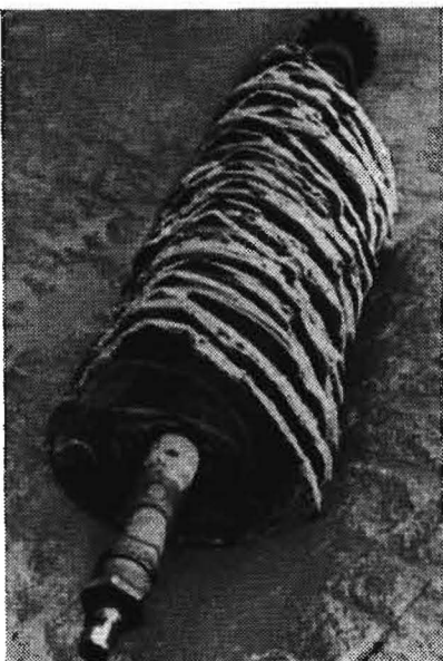
Bild 4. Siebwellen mit bogendreieckförmigen Siebscheiben nach der Erprobung bei steinhaltigen und feuchten Einsatzbedingungen
