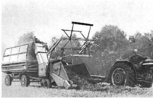
Bild 2. Trommelfeldhäcksler E 066 bei der Welkgut-Aufnahme aus dem Schwad
