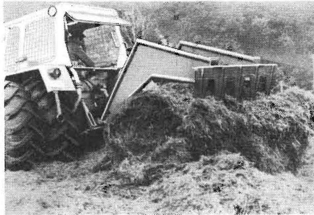
Die Welkgutdurchsätze des kombinierten Schlegelfeldhäckslers in der Grundzeit  $T_1$  (10 t/h) liegen bei Welkgut mit 30 bis 35 % Trockenmassegehalt nur unwesentlich unter denen des Feldhäckslers E 066 (11,3 t/h).
