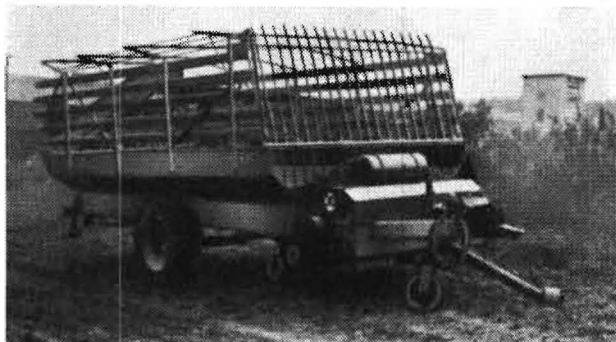
Bild 2. Futterladewagen FLW-E 5, Leichtgutteil für die Grünfütterernte abgeklappt
