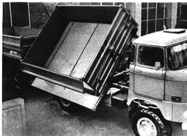
Bild 4. Die Einsatzmöglichkeiten des LKW in der Landwirtschaft erhöhten sich weiter mit der Einführung des Allradtyps W 50 LA/Z - 2 SK 5 mit Niederdruckreifen 16-20 (Foto: G. SCHMIDT)
