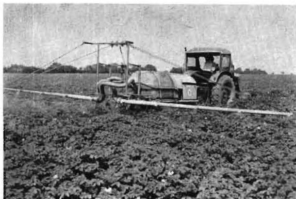
Bild 2. Die Spritz- und Stäubemaschine S 041 ist mit Uni-Barren für alle Pflanzenschutzarbeiten im Feldbau einsetzbar (Werkfoto)
