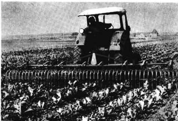
Bild 2. Heckanbau-Vielfachgerät P 433 mit 5 m Arbeitsbreite bei Pflegemaßnahmen im Gemüsebohnenanbau (Foto: Rosenthal)
