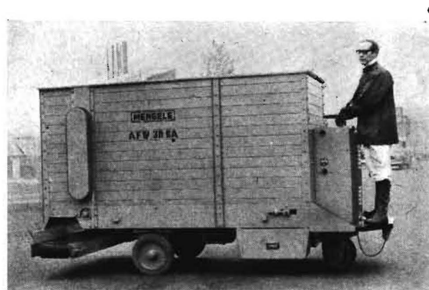
Bild 6. Der automatische Futterwagen „Mengele“ gehörte zu den ungewöhnlichsten Fahrzeugen der Messe. Mit dem AFW BA kann man nach rechts und links füttern; er besitzt Batterieantrieb und faßt 3 m 3
