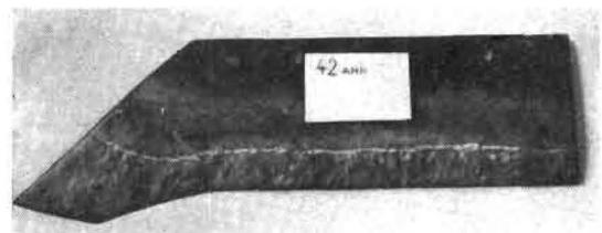
Bild 7. Diese Art der Auftragsschweißung auf der Hauptschneide hinten ist bei Verwendung von Schweißstäben des VEB Hartmetallwerk Immelborn zu empfehlen. Hinter der Scharspitze muß die Panzerung breiter gehalten werden
