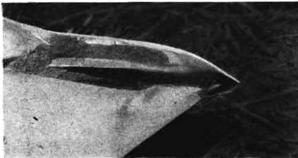
Bild 5. Deutlich erkennbare höhere Abnutzung der Oberseite des Meißels, die Hartmetall-Legierung Sormajit nutzt sich relativ wenig ab und ergibt so den Selbstschärfeffekt
