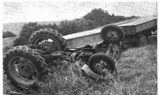
Bild 1. In der LPG Potzlow, Kreis Prenzlau, stürzte dieser U 45 durch die Schubkraft zweier mit Getreide vollbeladenen Hänger beim Befahren eines Gefälles von 22 % um. Der Traktorist wurde dabei tödlich verletzt
