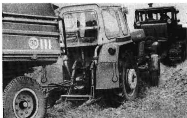
Bild 1. Sollte der Vergangenheit angehören: Das Überfahren der Silos mit zusätzlichen schweren Traktoren
