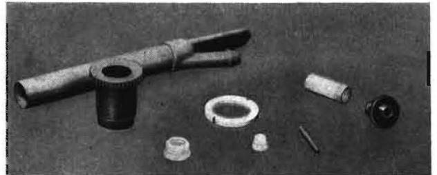
Bild 4. Einzelteile der Ventilrundtränke
