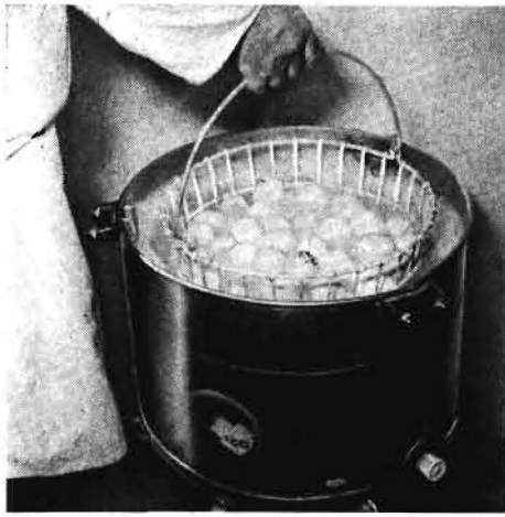
Bild 1. Waschmaschine mit plastisoliertem Drahtkorb für die Naßreinigung
