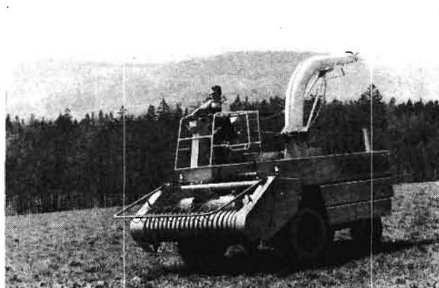
Bild 4. Exaktfeldhäcksler E 280/03 mit vorgebautem, 4,20 m breitem Schneidwerk
