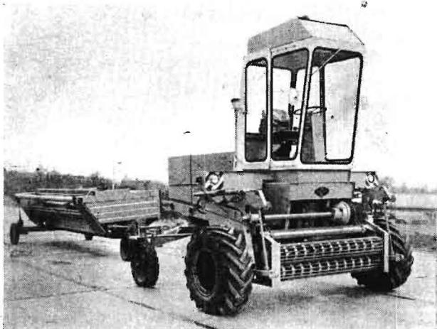
Bild 3. Selbstfahrender Exaktfeldhäcksler E 280/01 mit vorgebauter Schwadaufnahmetrommel
