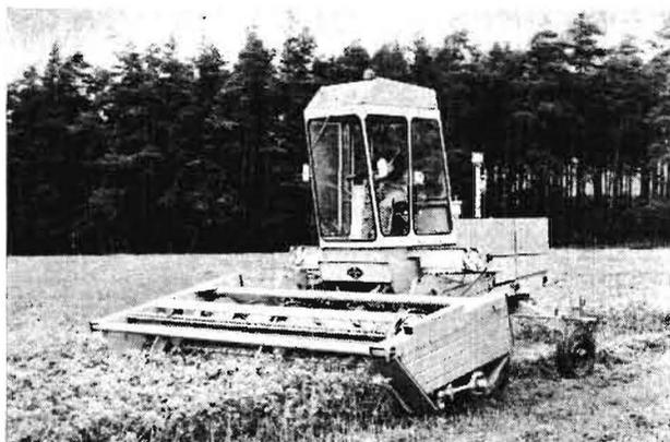
Bild 2. Schwadmäher E 301 mit angehängtem Schneidwerkswagen zum Straßentransport. Vorn sind die beiden Knickwalzen sichtbar
