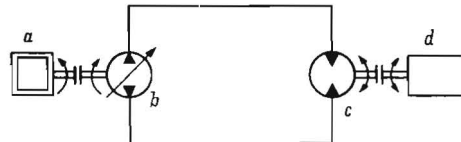
Bild 4. Hydrostatischer Antrieb mit offenem Kreislauf. a Antriebsmotor, b Hydropumpe, c Wegeventil, d Hydromotor, e Arbeitsmaschine
