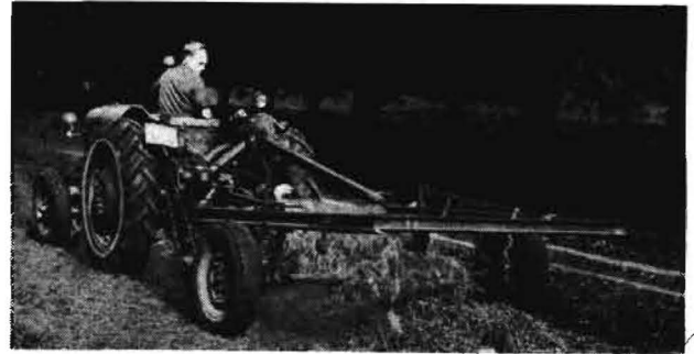
Bild 6. Gerät zur Untersuchung der Steinaufnahme durch Schwadaufnehmertrommeln
