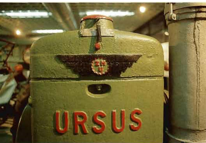
Polnischer Bulldog, um 1952, baugleich mit einem einst in Mannheim gebauten Lanz-Bulldog.
