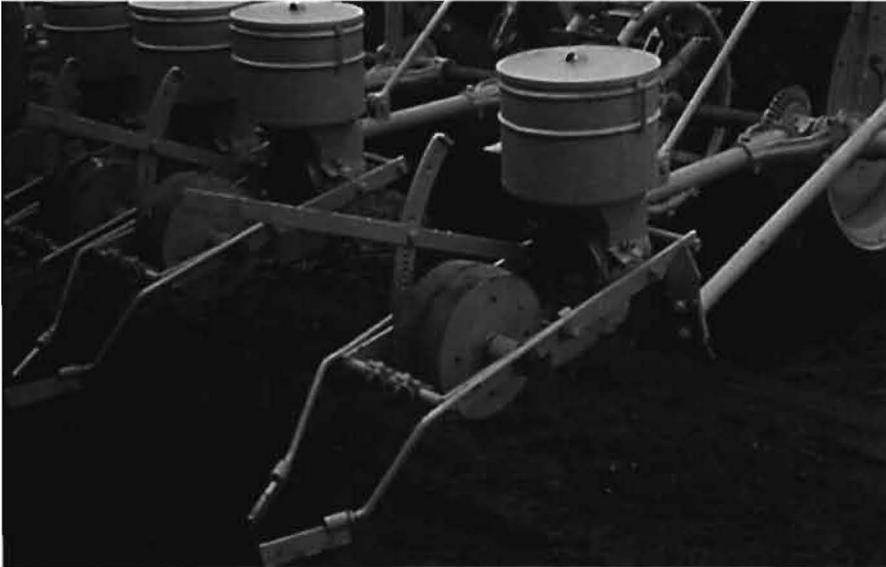
Einzelkornsämaschine „Multiculta“ mit einer Zellentrommel, die sich quer zur Fahrtrichtung dreht.
