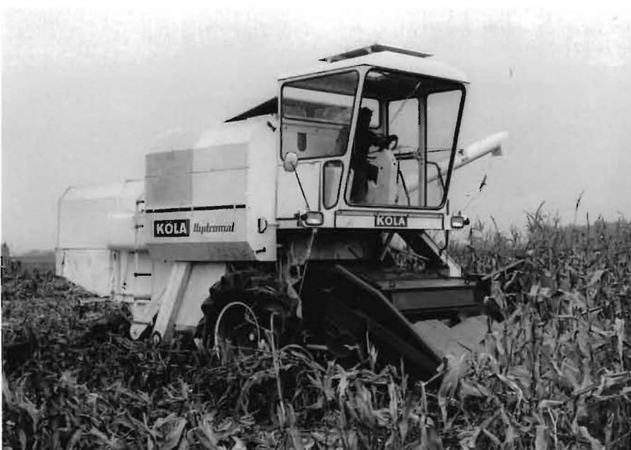
Bild 12: Selbstfahrer-Mähdrescher mit hydrostatischem Fahrtrieb
