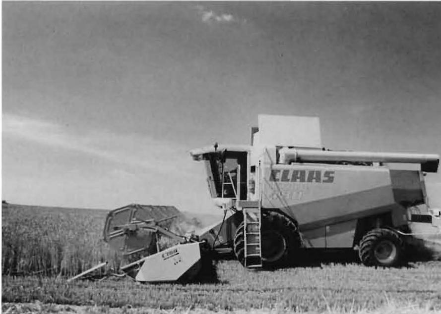
Bild 11: Selbstfahrer-Mähdrescher 1996, Lexion 480 (Werkbild Claas)
