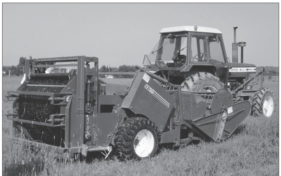
Bild 13: Gezogener Mähintensivaufbereiter mit (Bild) und ohne Mattentechnik einsetzbar (Kanada)
