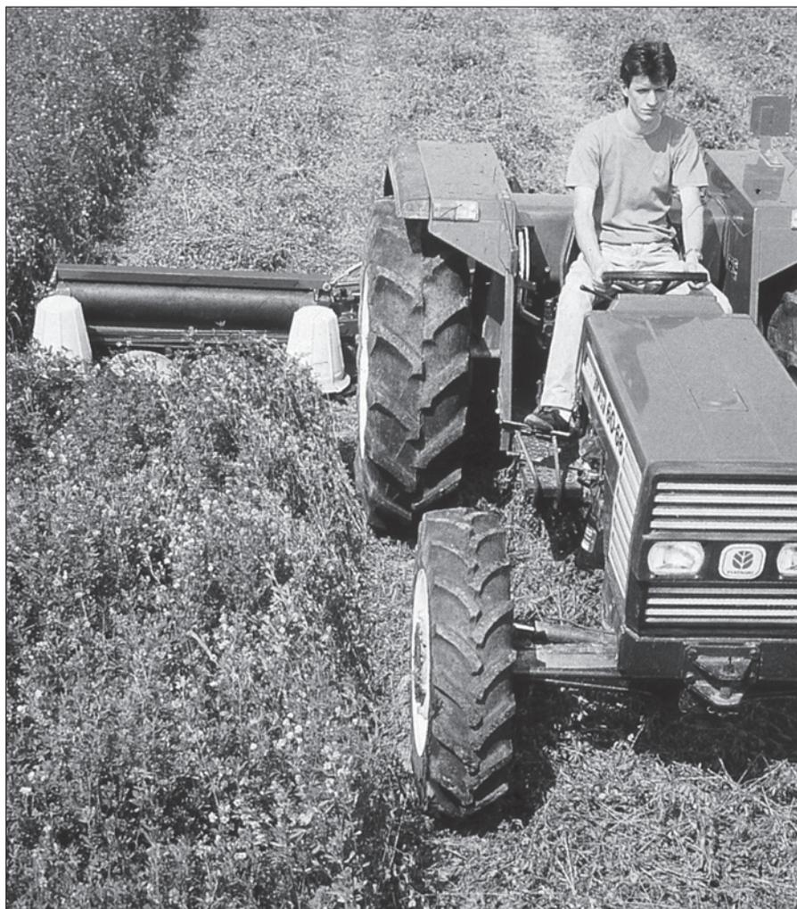
*Bild 6: Walzen-Quetsch-Aufbereiter mit Luftinnendruck, anpaßbar an Luzerne, Gras oder ungleichmäßige Mähschwads*
