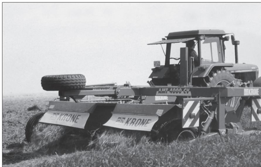
Bild 9: Unabhängig voneinander arbeitende Aufbereiter an einem Mähwerk mit mehr als 4 m Arbeitsbreite
