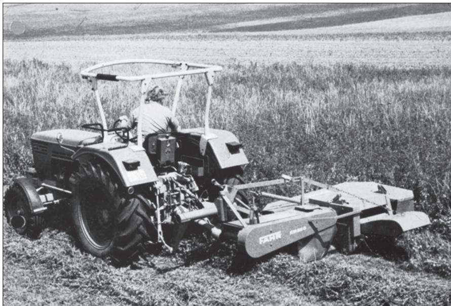
*Bild 5: Mäh-Quetschzetter mit gerippten Walzen am Trommelmähwerk bereitet stark auf, legt aber schmal ab*
