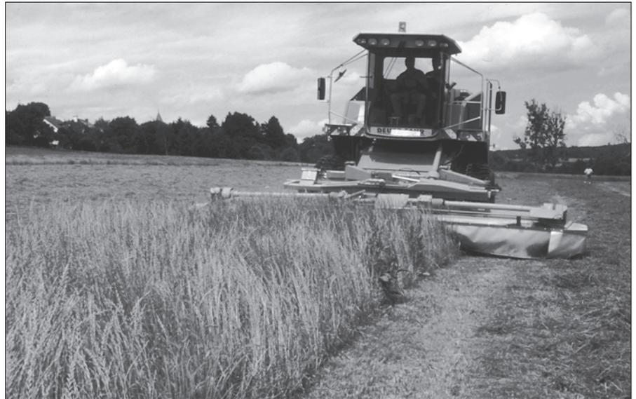
Bild 12: „Grasant“, der selbstfahrende Mähintensivaufbereiter. Prototyp der neuen Aufbereitergeneration
