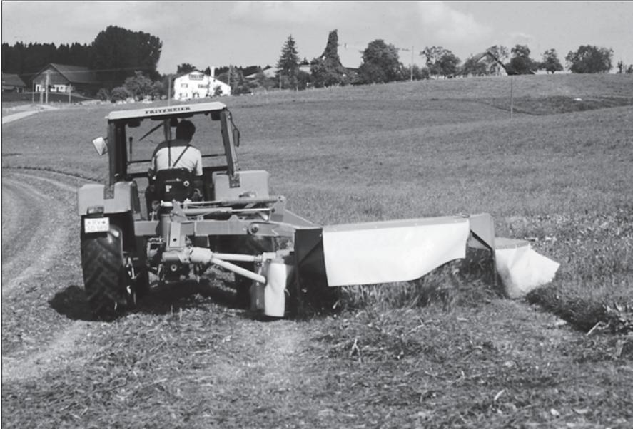
Bild 7: Rotoren mit V-förmigen Kunststoffingern am pendelnd aufgehängten Scheibenmäherwerk machen den Aufbereiter leicht und kompakt
