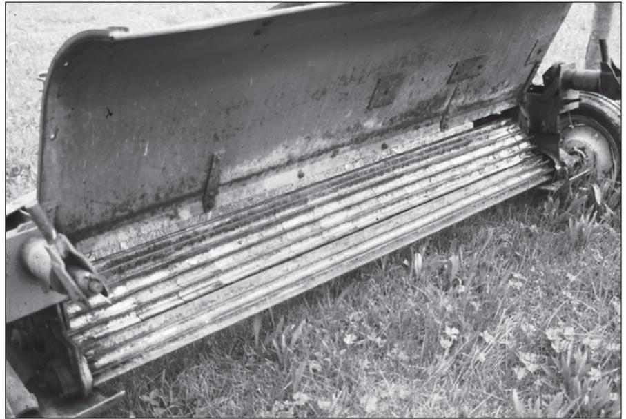
Bild 3: Knickzetter mit zahnartig profilierten Walzen arbeitet unabhängig vom Mähen (1960)
