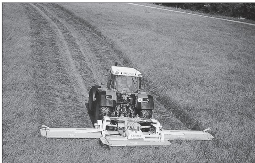
Bild 10: Kombination von Front- und Seitenmähwerken für Mähleistungen von 8 bis 10 ha je Stunde
