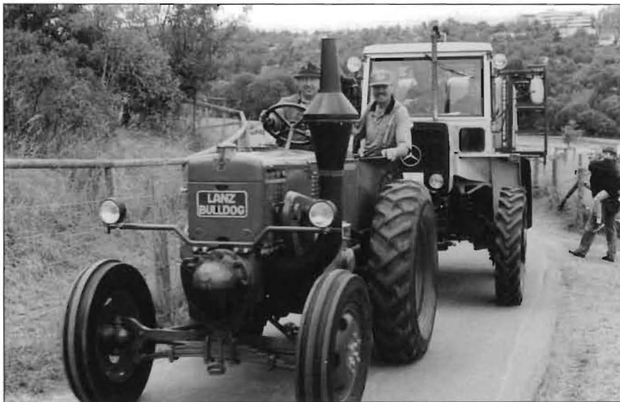
Der 35-PS-Bulldog hat 6 Vor- und 2 Rückwärtsgänge. Am Lenker: R. Leitenberger
