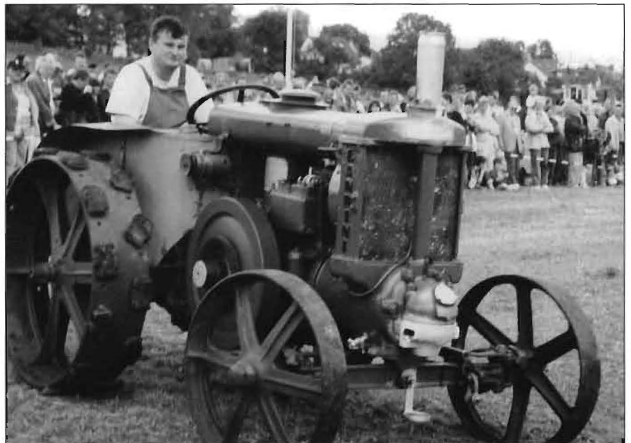
Eisenräder mit Hartgummikissen, aufmontiert auf R. Burke's Landini
