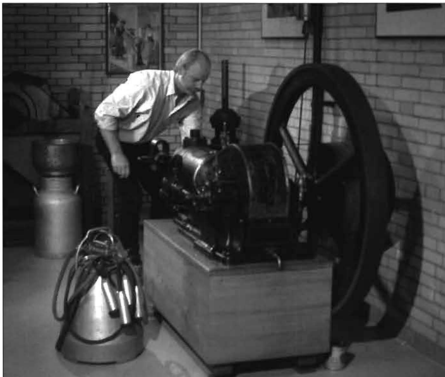
Westfalia-Melkmaschine, Bauj. 1928 mit Baumann-Stationärmotor, Bauj. 1905. In Betrieb gesetzt durch Obering. K. Lutz.
